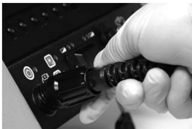
Figuur 17 – Aansluiten op een SeeSnake CCU
