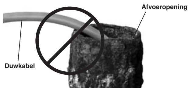
Figuur 23 – Vermijd het trekken in scherpe hoeken
